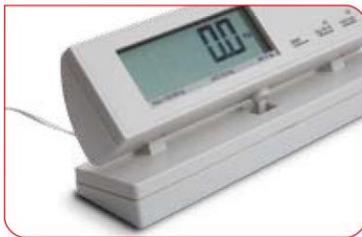
La inclinación del elemento de indicación y de mando se puede variar en forma continua, sin escalas. Para colocar en la mesa o fijar a la pared.
